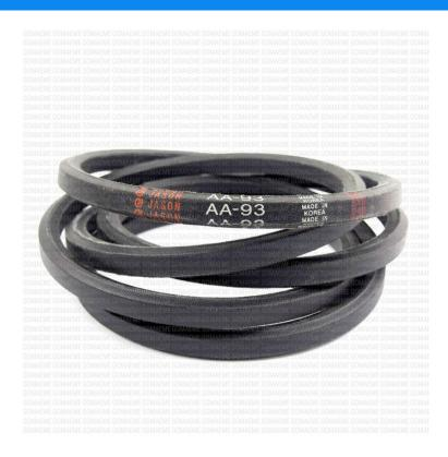
Correa hexagonal lisa ideal para transmisiones de potencia en ambos lados del mando. Compuesta de caucho y refuerzo de telas de poliéster, cubierto con una capa de tela de algodón y goma resistene a la abrasión, el calor, el ozono, grasa, aceite o suciedad. Situado en el centro del cordón se entrelazan compuestos de caucho sintéticos especiales que aseguran una larga vida de la correa hexagonal.
