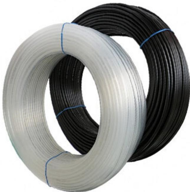
Las mangueras de Poliamida 12 (PA 12) son tubos de baja absorción de humedad y alta resistencia a una gran variedad de productos químicos. Tiene mejores propiedades mecánicas que la PA 6, es más flexible y liviano, soporta bajas presiones pero tiene la mejor resistencia a la corrosión por tensión de todas las poliamidas. También tiene buena a excelente resistencia a aceites, combustibles, fluidos hidráulicos y solventes. Se conectan mediante [acoples neumáticos](#).
