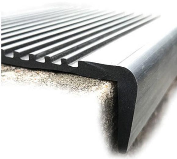
Cubre escalón de goma antideslizante. Ideal para areas de alto tránsito debido a su espesor de 3 a 5mm. Dibujo bastonado que impide resbalarse. Profundidad total de 270mm, y se puede recortar de acuerdo a la profundidad del escalón donde debe colocarse. Debe pegarse con [cemento de contacto](#) para su perfecta adherencia.
